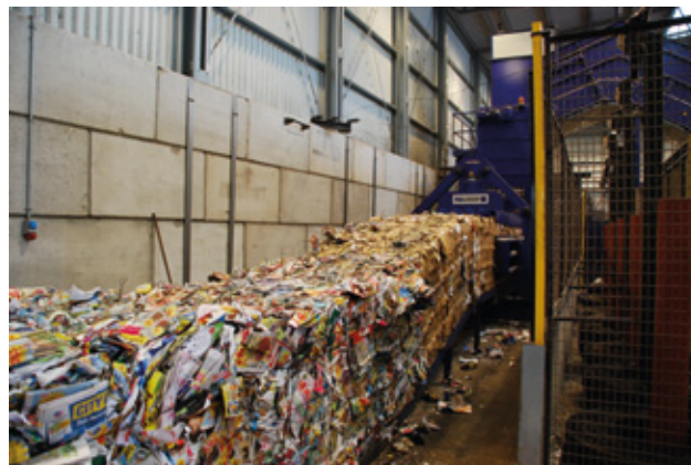
Tidningar buntas till balar på Sitas återvinningscentral. Dessa fraktas sedan till ett pappersbruk.
